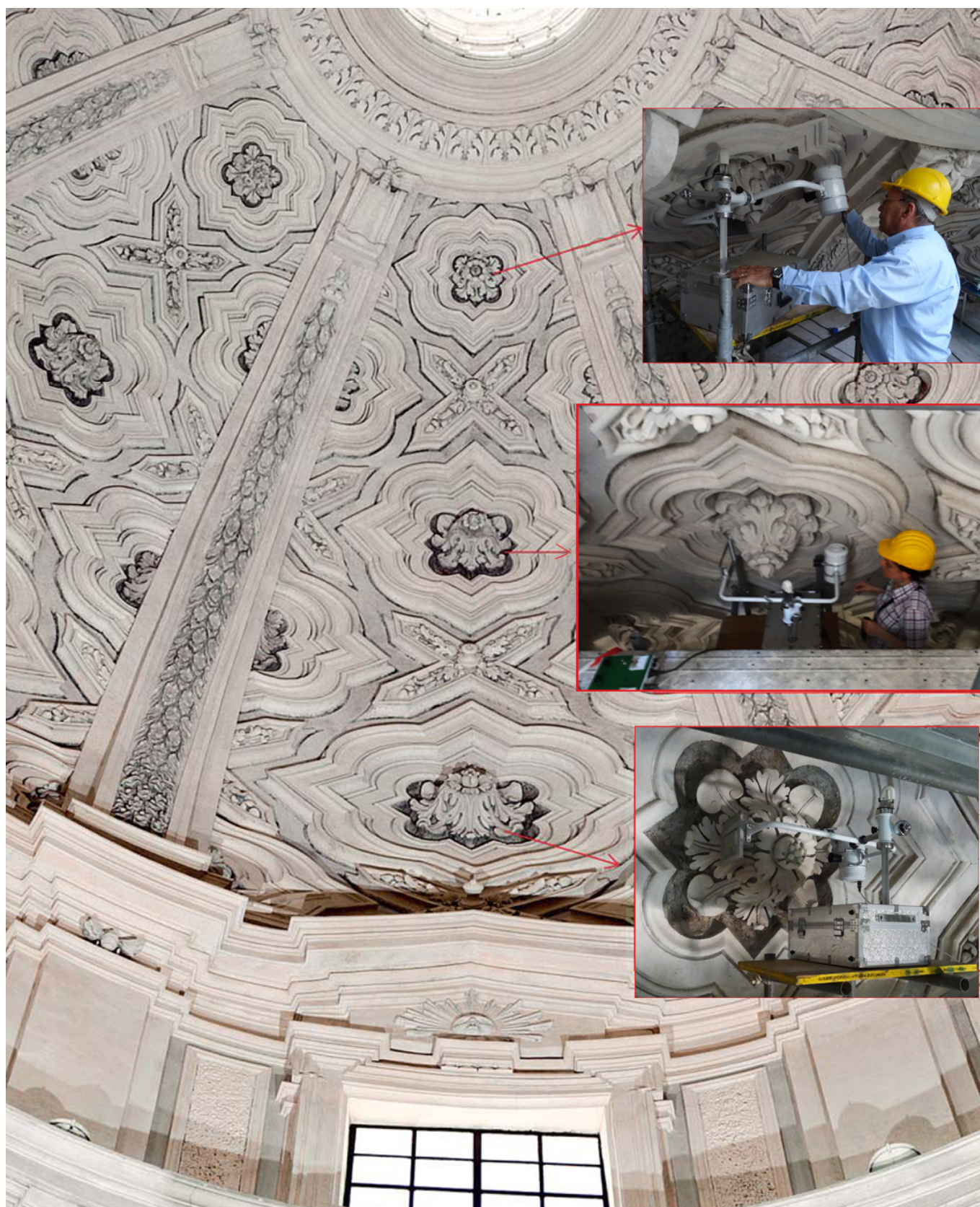
Fig. 7 Particolare della cupola con le tre tipologie di rosoni analizzate, nei box sono riportate le varie fasi dello svolgimento delle analisi radiografiche.
