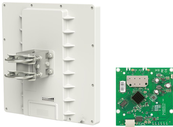
Fig. 3 Antenna Mikrotik QRT 5 e scheda router interna
