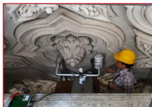
La radiografia a raggi X è una tecnica d'indagine non distruttiva, che consente di ottenere immagini delle strutture interne di un oggetto. Per l'utilizzo della tecnica di indagine per lo studio di decorazioni architettoniche è stato necessario realizzare uno strumento trasportabile ad hoc. Questo rapporto descrive la strumentazione realizzata per lo studio delle decorazioni architettoniche della chiesa dei SS Luca e Martina in Roma.
