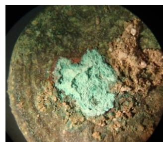
Fig. 12 Moneta archeologica: è evidente l'attacco del cancro del bronzo.
