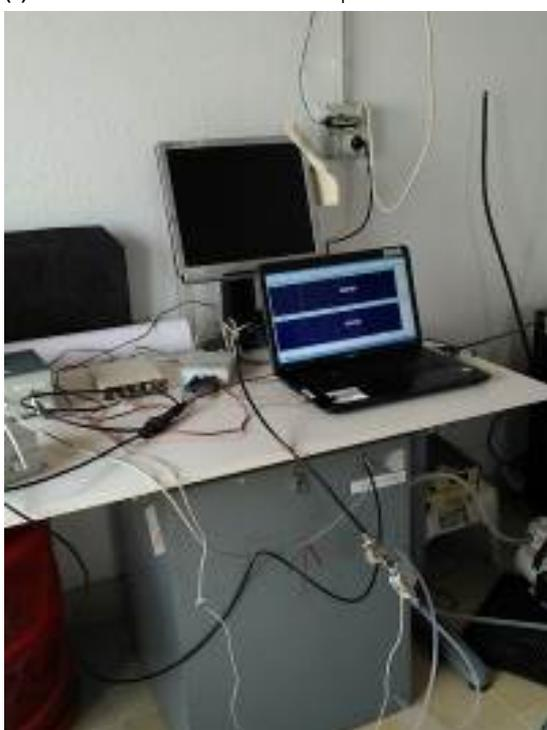
(c) Sistema per la misura del  $^{222}\text{Rn}$
